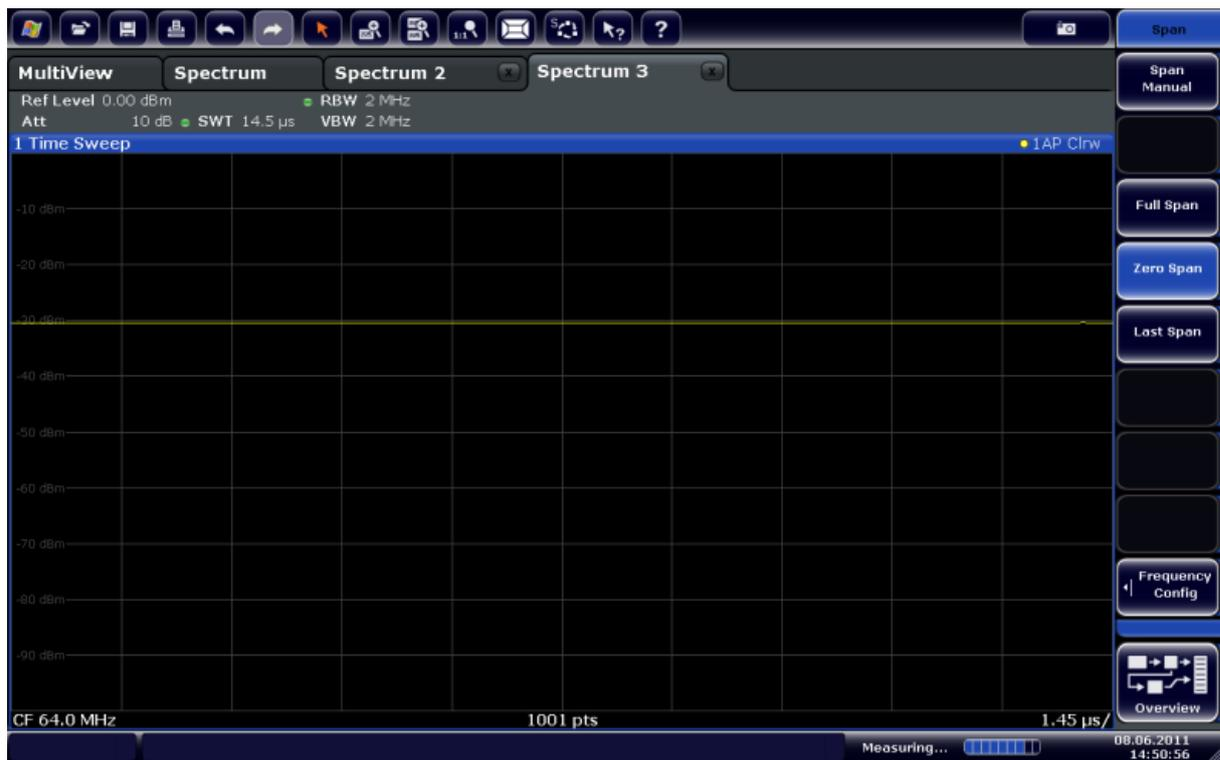
**Bild 4-7: Anzeige des Kalibriersignals im Zeitbereich**
