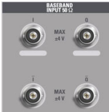
Die oberen BNC-Anschlüsse BASEBAND INPUT I und BASEBAND INPUT Q dienen als Eingänge für unipolare Signale, für das positive Signal für Differenzsignale sowie für Signale von aktiven **Rohde & Schwarz-Tastköpfen** (R&S RT-ZSxx und Differenzastköpfe RT-ZDxx).
